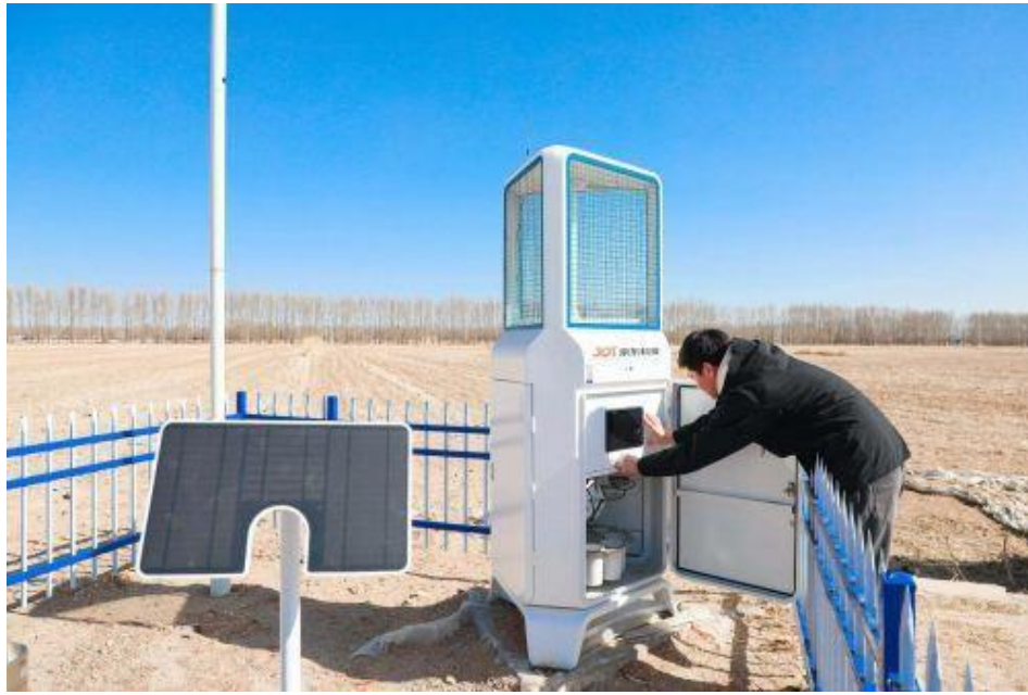
京东科技库伦荞麦基地虫情测报灯可实时检测反馈病虫害防治情况
